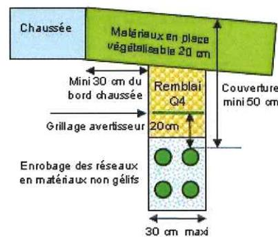
Les tranchées longitudinales sous accotements sont positionnées de manière à réserver une distance au moins égale à la profondeur de la fouille, distance comptée entre le bord de la chaussée et le bord le plus proche de la tranchée : dans ce cas, la tranchée respecte la coupe type « Accotements » correspondante.
