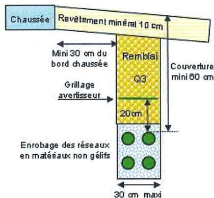
Les tranchées longitudinales sous accotements sont positionnées de manière à réserver une distance au moins égale à la profondeur de la fouille, distance comptée entre le bord de la chaussée et le bord le plus proche de la tranchée : dans ce cas, la tranchée respecte la coupe type « Accotements » correspondante.
